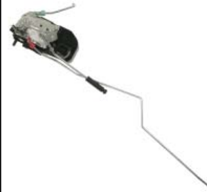
DLA-615 Power Door Lock Actuator 55394234AF; 55394234AG; 55394234AH; 55394234AI; 55113376AA; 55113376AC; 55394234AE; 55394234AD; 55113376AB
